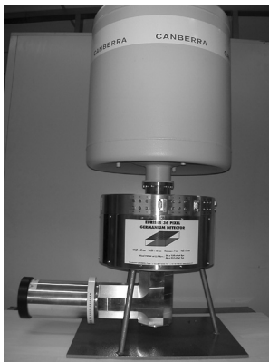
36 Pixel: Germanium detector.
